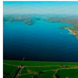
Cette dernière pointe de crue, bien que fortement atténuée par l'effet des lacs réservoirs, s'est propagée vers l'aval et s'est trouvée renforcée par les nombreux affluents de l'Aube et de la Seine situés entre les lacs-réservoirs et le secteur de la Bassée aval (Superbe, Ardusson, Voulzie ...), formant ainsi une pointe de crue observée le 25 mars à Pont-sur-Seine et le 28 mars à Bray-sur-Seine. Cette pointe n'a donc en aucun cas été provoquée par des délestages provenant de nos ouvrages.
